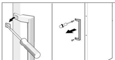
Дверная ручка устанавливается в обратной последовательности, см. раздел Сборка дверной ручки настоящего Руководства.
