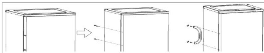
Снимите заглушки с внешней стороны дверцы и затяните ручку с помощью поставляемых винтов в отверстиях под ней. Наденьте прилагаемые заглушки винтов.
