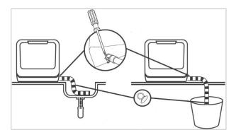
Подсоедините сливной шланг к задней части прибора. Разъем снабжен зажимами и должен быть закреплен отверткой.  Надежно закрепите конец шланга в раковине или ведре. Закрепите сливной шланг присосками.
