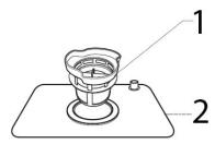
Система фильтрации предотвращает попадание большого количества пищи или других предметов внутрь помпы.
