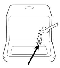
Добавляйте моющее средство перед началом каждого цикла полоскания в соответствии с инструкциями, представленными в Таблице программ.
