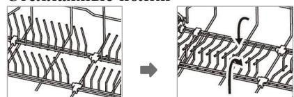
Для более удобного размещения громоздкой посуды полки стеллажа можно сложить. Слегка приподнимите полки и сложите их.
