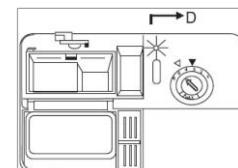
не загорается на дисплее, вы можете оценить количество оставшегося ополаскивателя по оптическому индикатору уровня (D) рядом с дозатором.
