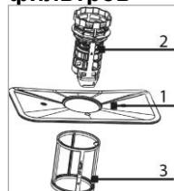
Трехкомпонентная система фильтрации предотвращает попадание больших объемов пищи или других предметов внутрь насоса.
