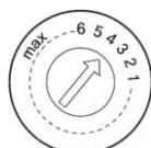
Снимите крышку дозатора ополаскивателя и отрегулируйте шкалу на требуемый уровень. Заводская установка – «4».
