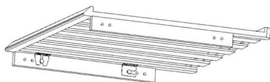
Осторожно выдвиньте полку с рейкой как можно дальше. Затем приподнимите переднюю полку, чтобы отсоединить ее от направляющей. Затем потяните полку вперед и отсоедините ее от задней части направляющей.
