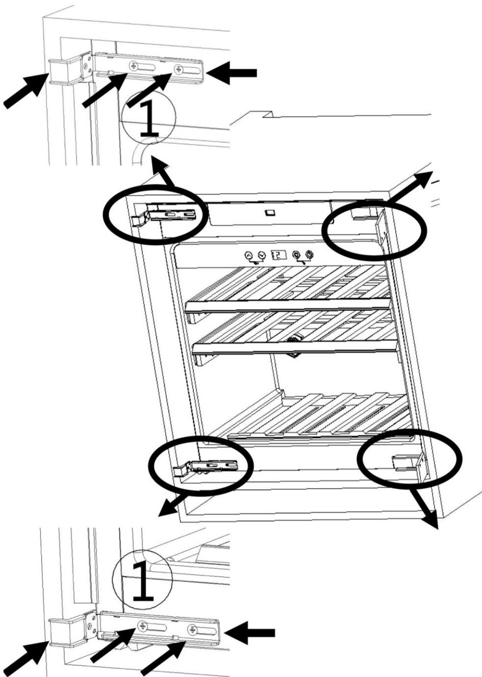
1. Прикрепите прибор к кухонному шкафу винтами через петли и монтажные скобы.
