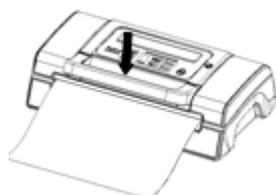
Нажмите кнопку „Вакуум & Запаивание“ / "Прерывание". Дисплей считает в обратном порядке, воздух автоматически откачивается. В заключении пакет запаивается, в это время загорается индикаторная лампочка "Запаивание", на дисплее идет обратный отсчет до 0.
