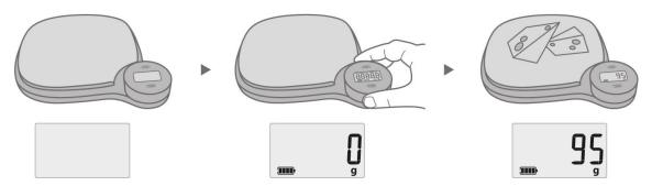
Поместите весы на твердую и ровную поверхность. Поворачивайте регулятор по часовой стрелке до тех пор, пока не увидите на дисплее значение 0. Поместите продукты на весы и их вес отобразится на дисплее.
