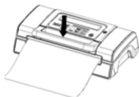
Проверьте светодиодную индикацию состояния и выберите нужные вам время запаивания и степень вакуума.
