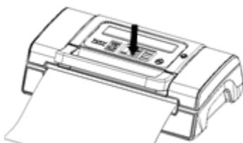
Загорается индикаторная лампочка "Запаивание". Дисплей ведет обратный отсчет до 0. Индикаторная лампочка гаснет, когда процесс запаивания закончен.
