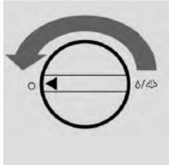
**Шаг 8:** (удаление воздуха) начать подачу горячей воды. Поверните поворотную ручку вправо. Прибор должен подавать горячую воду, пока не пойдет вода без воздуха.
